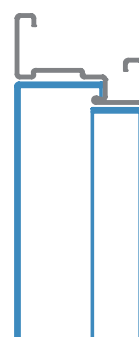
sopraluce cieco tamponato con lamiera
