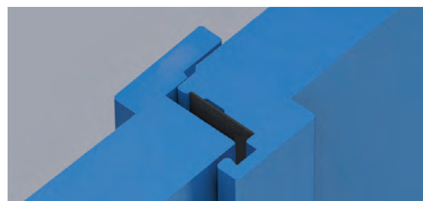
Coupe horizontale de la jonction des vantaux
