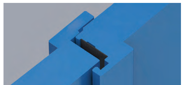
Coupe horizontale de la jonction des vantaux
